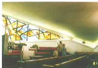
ヌエストラ・セニョラの礼拝堂 (1955)。スパンは対角線方向に各々25m、30m。きわめてシンプルで明快な単一のHPシェル。
