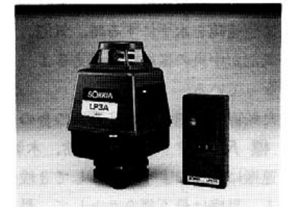
図 5.9 (a) レーザ光線を使用した水準器 (KK ソキア レベルプレナー P3A) (b) 受光器 (KK ソキア LPR3A)
