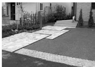
■図19 仕上げ素材で変化をつける（アプローチ：石英岩系自然石の乱貼り、駐車場：コンクリート洗い出し、道路との見切り：ピンコロ）
