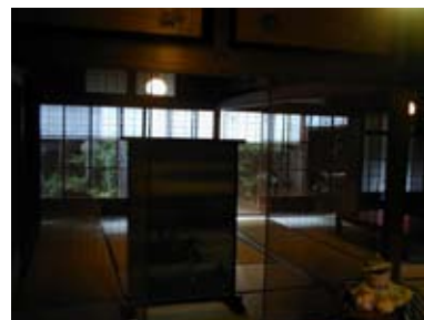
図2 日光をほどよく入れる夏季の民家(飛騨高山) 大量の日光を室内に入れられないようすだれなどで調整して涼しさが得られるようにしている
