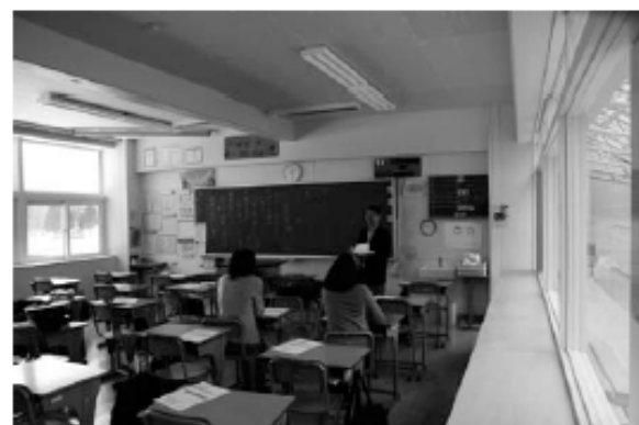
図6 南北両面採光を行う教室内部 教室の蛍光灯を点灯しなくても、十分に採光ができる明るさを確保している（北海道豊原郡黒松町立黒松中学校）
