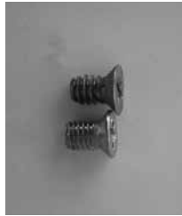
fig5-4 ねじ山間の寸法が異なるビス(上:古い住宅に使用されていたねじ 下:現在出回っているねじ)
