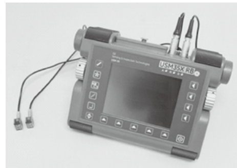
写真Ⅲ-9.2 超音波探傷検査装置の例
