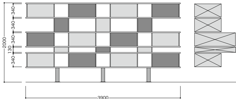
実測図。右側の図の ⊗ は各段に入る薄い板（スライド戸）の大きさである。特に下から2段目の板は通常考えられないような高さで横のプロポジションであるが、左端から右端まで指一本でスムーズな引き通しが可能となり、板の位置により様相が変化する見事なデザイン
