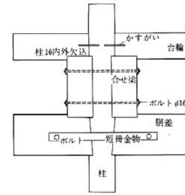
合せ梁と柱、胴差し、台輪の取合い
