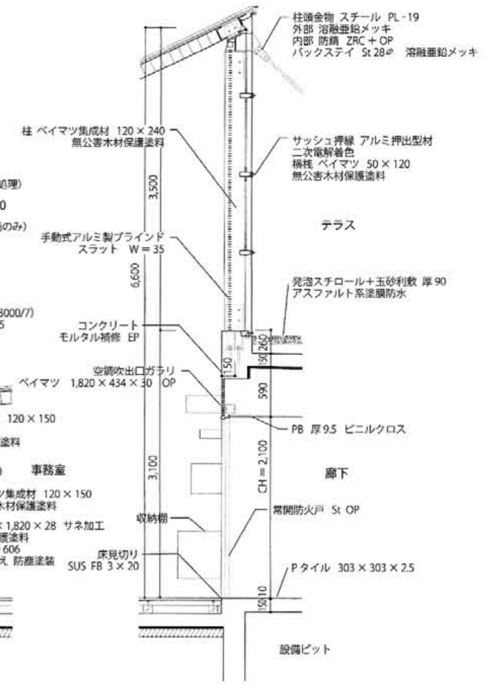
吊り屋根断面詳細図 1/60
