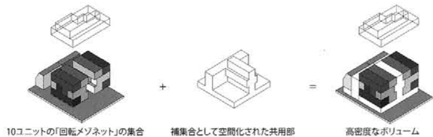
図2.26 立体積層による高密度集合(川口交差住居/アーキテクチャー・ラボ)
