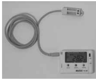
写真 2 サーマスタと高分子型湿度センサーを利用した携帯型湿度計
