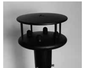
写真 5 二次元超音波風向風速計
