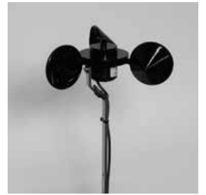
写真 4 小型三杯式風速計
