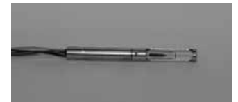
写真 6 熱線式風速計
