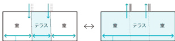
建具を閉じると、箱の内側はテラスを中庭のように狭む構成 建具を開放すると、箱の内側は外の空気が湿り合う空間になる
