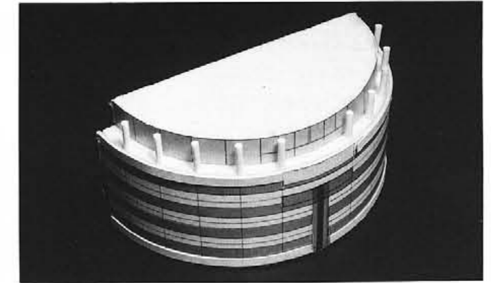
天井材に柱材を突き刺して長さや傾きを調整する(左の写真を天地逆にしたところ)
