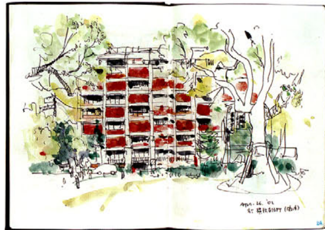
外壁のデザインは柱梁の構造をそのまま表現し、繰り返しのパターンの連続に見える。しかし描いてみると、柱は上階で絞られ、生の構造躯体に意匠が加味されていること、壁と窓のパターンも必ずしも一定でないことに気づかされる。「横浜市庁舎」設計：村野・森建築設計事務所、1959年（スケッチノートに水性ペン+透明水彩）
