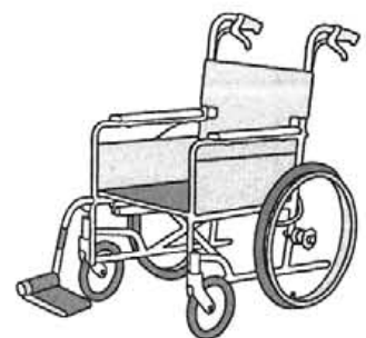
片まひ者用に製作された片手片足駆動型車いす。床面を直接蹴って駆動できるように座面が低く作られている。健側の駆動輪に取り付けたハンドリムの片手操作と組み合わせて駆動させる。自走用車いすの一種
