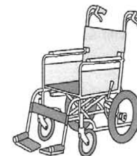
使用者自らは操作せず、介助者が操作することを目的とした車いす。駆動輪は小さく、ハンドリムがない。自走用よりも全幅が細く取り回しは楽である
