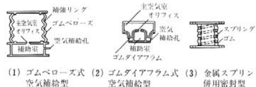
図 4-22 空気ばねの構造
