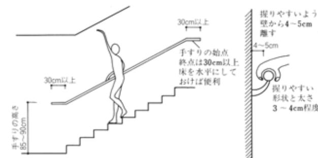
図5 階段の手すり
