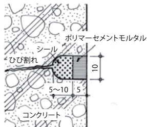
図-1 Uカットシールの断面
