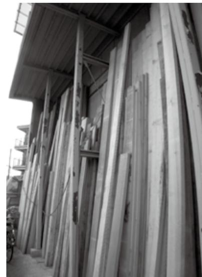
加工前の建具材の置き場。濡らさないように屋根下で自然乾燥させる
