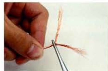
④ 素線を2分割して片方を次の枝分かれ位置までさらによじる
