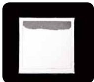
② 開口部の部材に、窓枠を表現する切り込みを入れる。着色ペンでムラにならないように素早く塗る。切り込みがエッジとなって塗料がはみ出ない。
