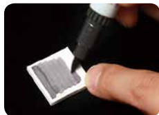
② 開口部の部材に、窓枠を表現する切り込みを入れる。着色ペンでムラにならないように素早く塗る。切り込みがエッジとなって塗料がはみ出ない。
