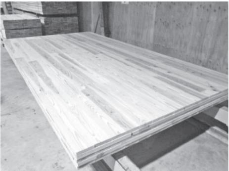
写真 2.2.7-1 5 層 5 プライ CLT 大型パネル (銘建工業)
