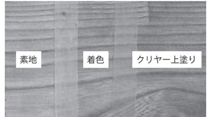
写真4 塗料の吸い込み方の違いで木目が鮮明に現れる（ニレ材）
