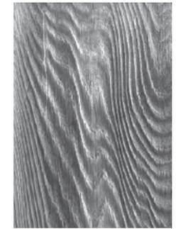
写真1 風化により晩材の木目が浮き出したスギ
